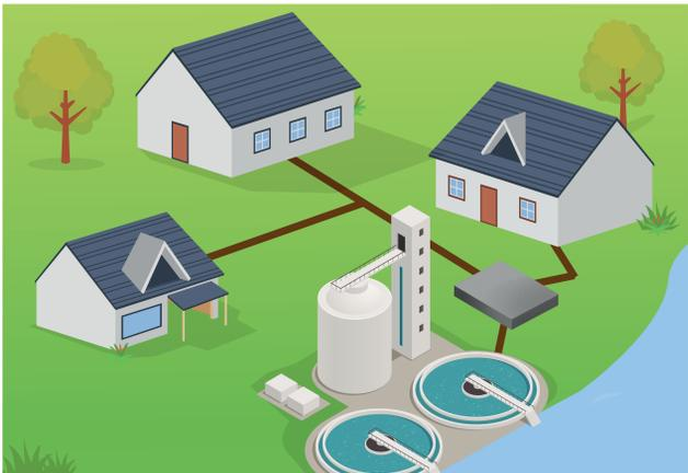
Depuis mon habitation, mes eaux usées arrivent dans le réseau collectif, passent par des pompes de relevage et sont amenées à la station d'épuration de ma commune. Après traitement, les eaux épurées sont rejetées dans le milieu naturel.
