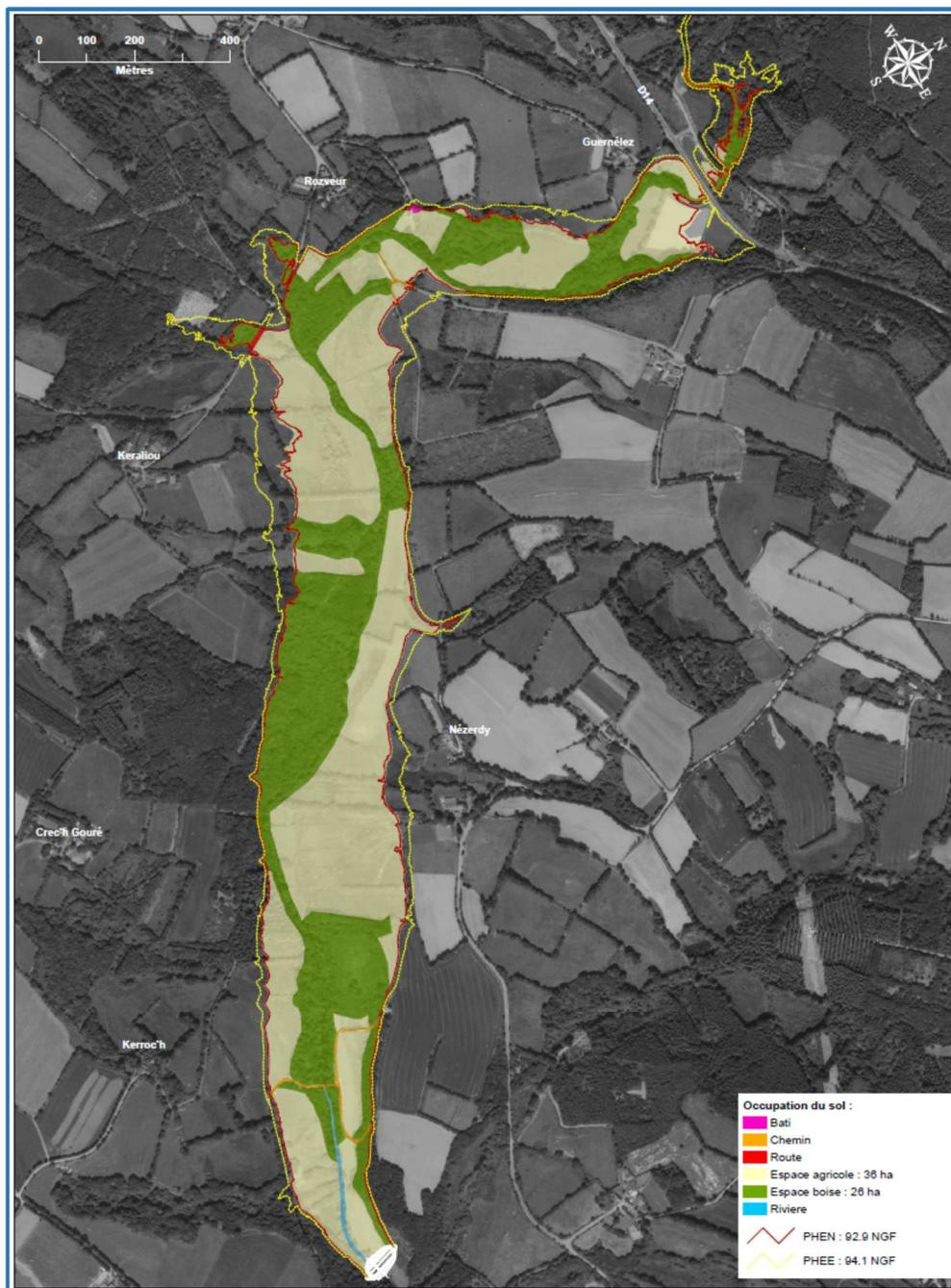
Figure 4 : Carte du périmètre de la retenue maximale estimée de l'ouvrage A12 sur l'Ellez (STUCKY – 2012)
